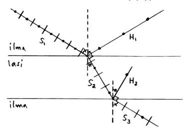
Yllä olevaan kuvaan on piirretty lasilevylle tuleva valonsäde  $S_1$ , heijastunut säde  $H_1$  ja taittunut säde  $S_2$ . Taittuneen säteen  $S_2$  osuessa seuraavaan lasin ja ilman rajapintaan, se osittain taittuu ja osittain heijastuu valonsäteiksi  $S_3$  ja  $H_2$ .
