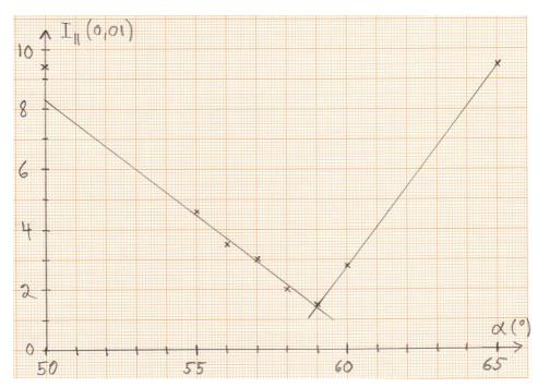
Kuvassa on esitetty suhteellinen intensiteetti  $I_{\parallel}$  tulokulman funktiona välillä 50° . . . 65°. Mittauspisteisiin voidaan sovittaa taitekohdan molemmin puolin suorat. Vasemmalla puolella kauimmainen mittauspiste ei sovi samalle suoralle muiden tulosten kanssa, mutta lähellä taitepistettä intensiteetti näyttää muuttuvan lineaarisesti. Kuvan perusteella  $I_{\parallel}$  on pienimmillään, kun tulokulma on 59°, joten se on hyvä arvio Brewsterin kulmalle. Brewsterin lain mukaan
